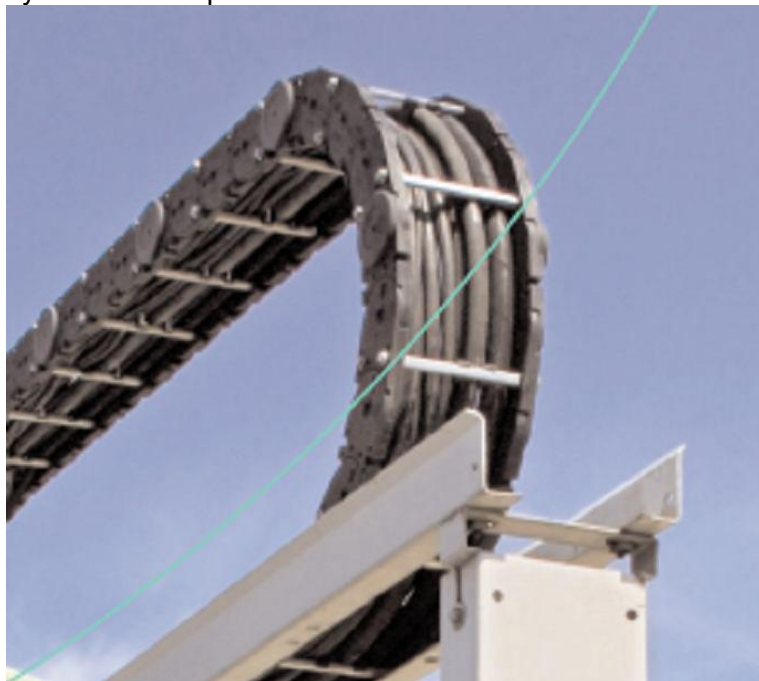
Гусеничный короб на колонне
