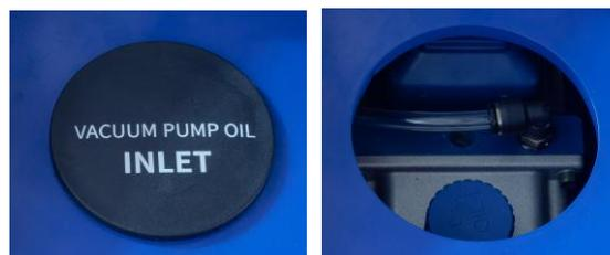
1.2. Отвинтите крышку маслоналивного отверстия вакуумного насоса.
