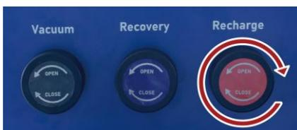
8.8. Поверните красный быстроразъемный соединитель высокого давления против часовой стрелки и отсоедините его. Синий быстроразъемный соединитель оставьте без изменений.
