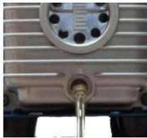
1.6. После слива отработанного масла закрутите пробку сливного отверстия.
