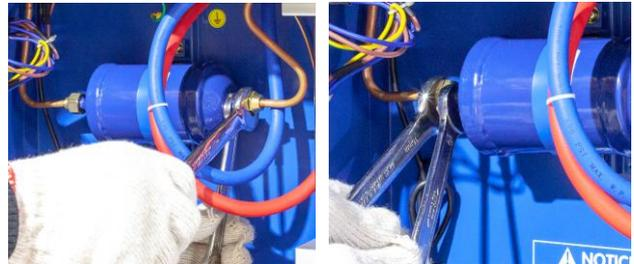
2.4. Откройте клапан слива масла на две секунды и спустите давление, накопленное внутри фильтра.
