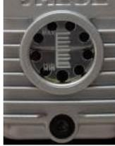
1.4. Разместите маслосборную емкость под отверстием слива масла из вакуумного насоса.
