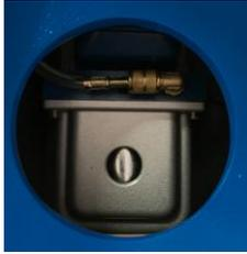
1.3. Открутите пробку откачки вакуумного насоса.
