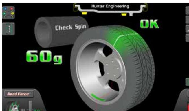
При включенной функции сервоостановки прикрепите приклеиваемый груз отображаемого на дисплее веса для правой грузовой плоскости. Программный инструмент TruWeight™ показывает оператору как точно установить груз на обод. Установите их точно как показано на экране.
