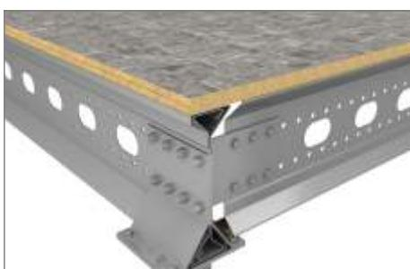
**3. Специализированное силовое ДСП** с антискользящим покрытием сверху и светоотражающим белым снизу. Обеспечивает ровную поверхность с высокими эксплуатационными свойствами, износостойкая антискользящая поверхность (по износостойкости значительно уступает перечисленным выше металлическим настилам, но при соблюдении правил эксплуатации - срок службы не менее 10 лет). Удобная и отработанная схемастыковки листов и крепежа.
