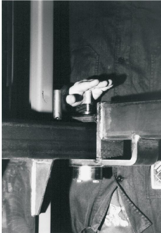
Рисунок 54. Контроль работы устройства блокировки лап.
